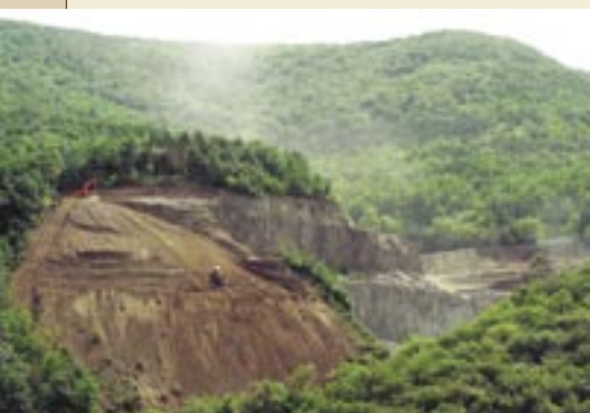
Postup ťažby andezitu a odstraňovanie skrývky v lome Šiator – pohľad zo západu (foto: R. Gális) Andezit fejtése a Sátor-hegyi-bányában. (R. Gális felvétele)
